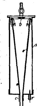
**C. G. Haubold A.-G., Chemnitz i. Sa. Kunstseiden-Topf spinnmaschine mit Schutzrohr** für die dem Zwi rnktrichter zu laufenden Fäden, dad. gek., daß das Schutzrohr der Länge nach aufklappbar ist. — Dadurch, daß dieses Rohr aufklappbar ist, kann man es leicht um den Faden herum schließen. Zeichn. (D. R. P. 421 340, Kl. 29 a, Gr. 6 vom 31. 8. 1924, ausg. 10. 11. 1925.) dn.
